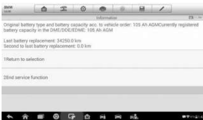
Рисунок 7-12. Пример третьего окна настройки системы управления аккумулятором
